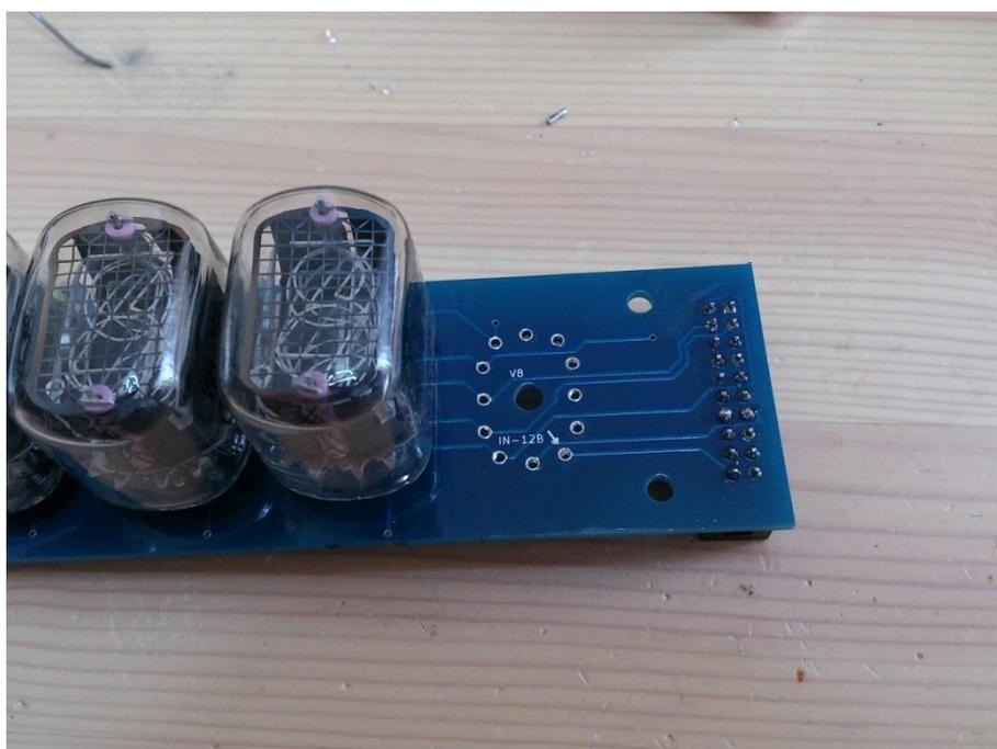
ニキシー管のはんだ付けについては、奥まで差し込むのではなく、写真のようにピンの先が基板のスルーホールから少し出るくらいで1ヶ所仮止めして他の管との高さや角度を調整するのが良いと思います。
